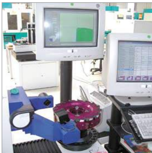
Messgerät zur Schneideneinstellung. Measure machine for cutting edge adjustment.
