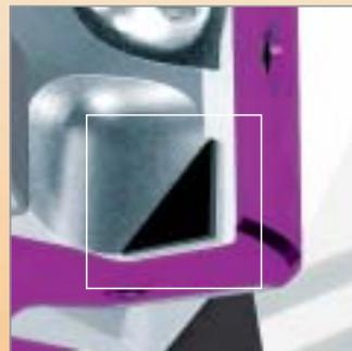
Hochpräziser Schneideinsatz mit PKD-Schneide
