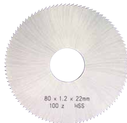
feingezahnt Form A Winkelzahn DIN 1840 (Spanwinkel 5°)
