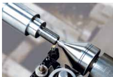
Die verlängerte Laufspitze garantiert beim Drehen von Teilen mit kleinen Durchmessern den erforderlichen Freiwinkel.
