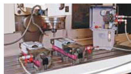
Typ NCH, hydraulisch betätigt - auf Anfrage lieferbar
