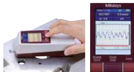
Profildarstellung in Echtzeit während der Messung
