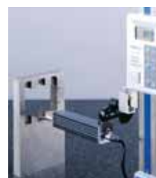
Einsatz mit Höhenmesser 5305020300 mittels Adapter 5705310016
