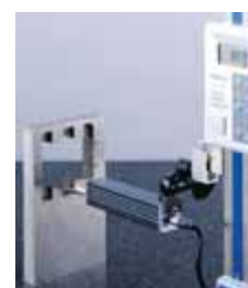
Einsatz mit Höhenmesser 5305020300 mittels Adapter 5705310016
