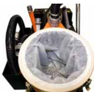
Filtereinsatz mit Spänen und Schleifschlamm
