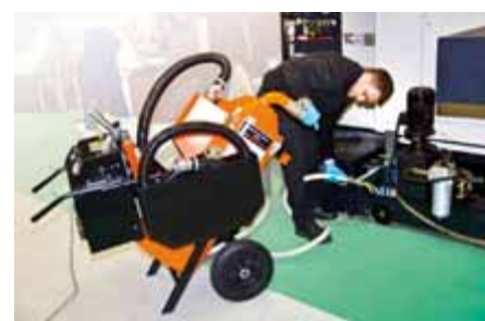
Rückführung der gereinigten Emulsion in den Kühlschmierstoff-Behälter
