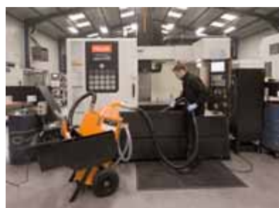
Aufsaugen von verschmutzter Emulsion, Spänen und Schleifschlamm
