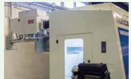
UC2-SDIII Wandmontage, rückwärtige Absaugung
