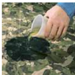
225 ml Öl werden auf der HAM-O ausgegossen...
