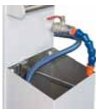
Ausleitung der Fremdöle in Behälter mit Niveauberschalter (Überlaufschutz)
