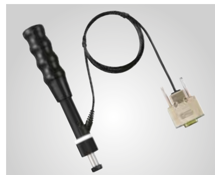
HLD + 15 Schlaggerät UD-414 Für Verzahnungen, verschweißte Ecken usw.
