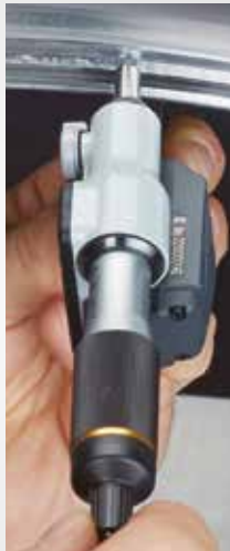
U-WAVE-TC für Messschieber mit Anschlusseinheit
