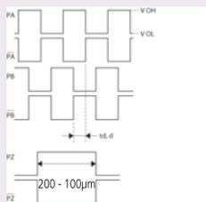
90° Phasenverschiebung, Differential-Rechtecksignal
