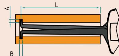
(1) Maximale Reichweite über Werkstück
