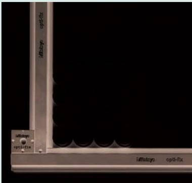
Bei Serienmessung von gleichen Teilen werden die Werkstücke in der Winkelvorrichtung positioniert.
