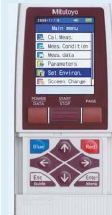
Tastatur mit geöffneter Schutzabdeckung
