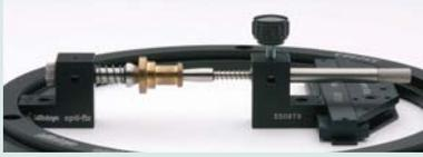
Klemmung eines zylindrischen Werkstücks zwischen Zentrierspitzen.
