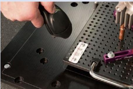
Start eines Teileprogramms mittels Barcode
