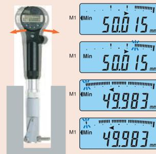
Das ABSOLUTE Digimatic Innenmessgerät erfasst den kleinsten Wert (Durchmesser) und hält den Wert automatisch.
