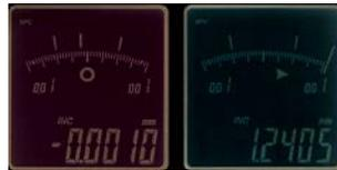
Das Display schaltet bei eingestellter Toleranzfunktion und Über- bzw. Unterschreitung der Toleranzgrenzen automatisch von grüne auf rote Hintergrundbeleuchtung.
