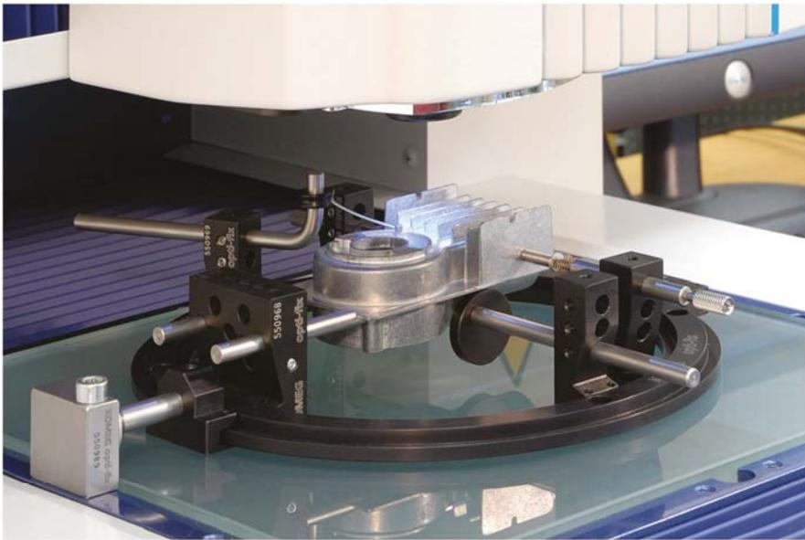
Anwendungsbeispiel eines Werkstücks mit OPTI-FIX welches eine korrekte Position garantiert. Hierbei wird das Spannsystem mit Magnethaltern, die am Tischrahmen angeschraubt sind, befestigt.
