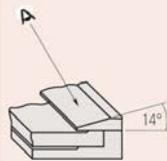
Einfache Ablesung durch 14° geneigte Noniusskala
