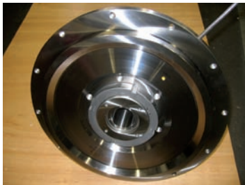
Zur Zentrierung von CBN-Schleifscheiben
