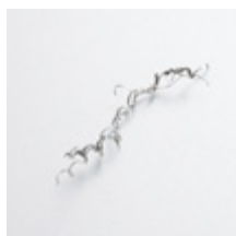
Späne eines herkömmlichen Gewindebohrers
