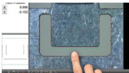
Einfache Messpunkterfassung durch Antippen des Elements im Live-Bild
