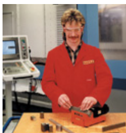
Maschinenlaufzeiten können für das Anfasen und Entgraten genutzt werden
