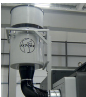
Montage auf Ständer und seitlicher Ansaugung
