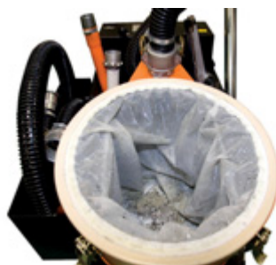
Filtereinsatz mit Spänen und Schleifschlamm
