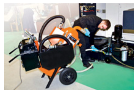
Rückführung der gereinigten Emulsion in den Kühlschmierstoff-Behälter
