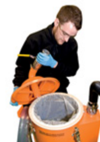
Gute Zugänglichkeit des Filtereinsatzes
