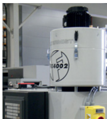
Direktmontage auf Drehautomaten
